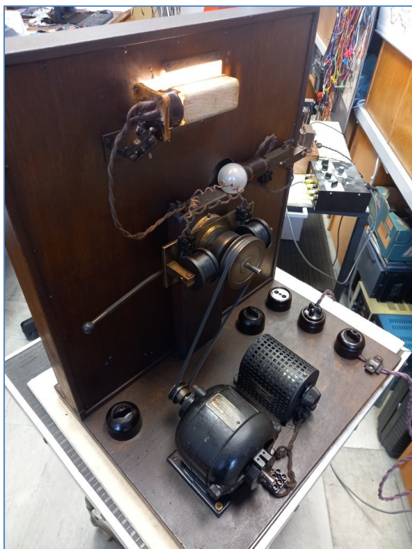
Mechanismus TV přijímače
