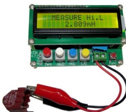
Měření indukčnosti – nezáleží na polaritě
