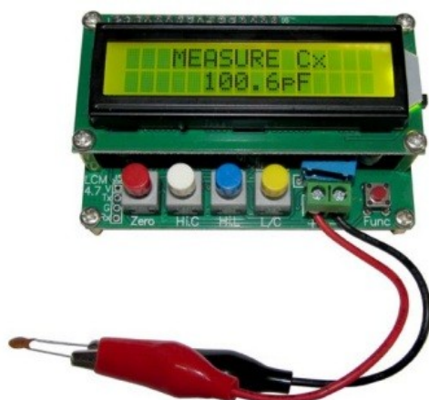
Měření keramických kondenzátorů – nezáleží na polaritě
