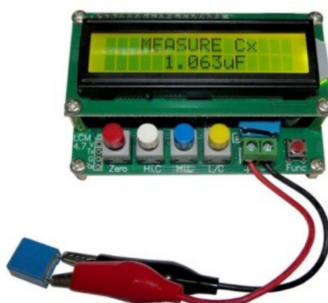
Měření svitkových kondenzátorů – nezáleží na polaritě
