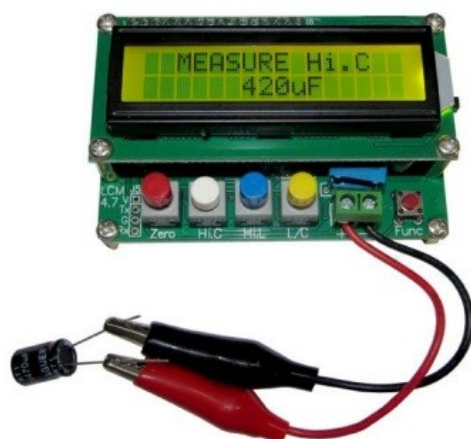
Měření elektrolytických kondenzátorů – záleží na polaritě!
