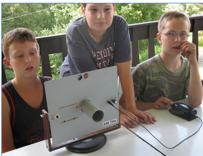
Laserový telegrafní transceiver (přijímač + vysílač) s dosahem ve stovkách metrů (limitováno jen stabilitou stavitu)
